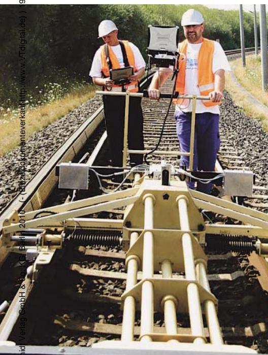
Bild 7: EMA zur Gleisgeometriemessung und Schienenscan
