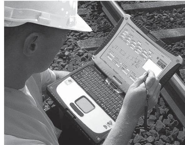
Bild 9: Nebenprüfung Gleis mit MR.pro®
