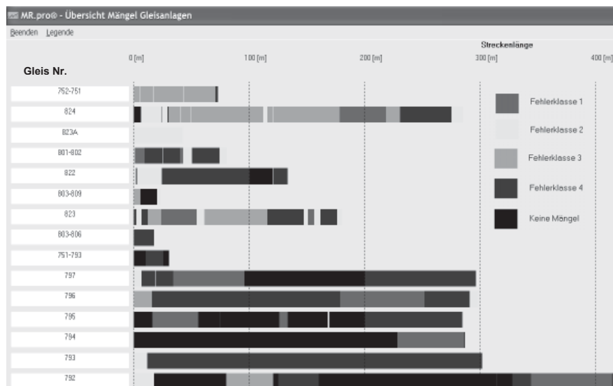
Bild 8: Die grafische Darstellung der klassifizierten Mängel unterstützt die Instandsetzungsentscheidung linear ausgedehnter Anlagenobjekte.
