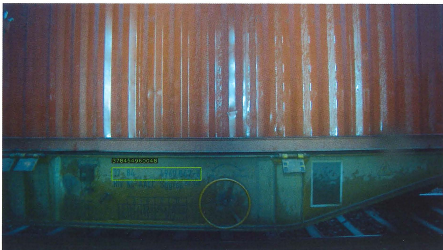
9: Erkennung der Wagennummern aus den RDG-Bildern
