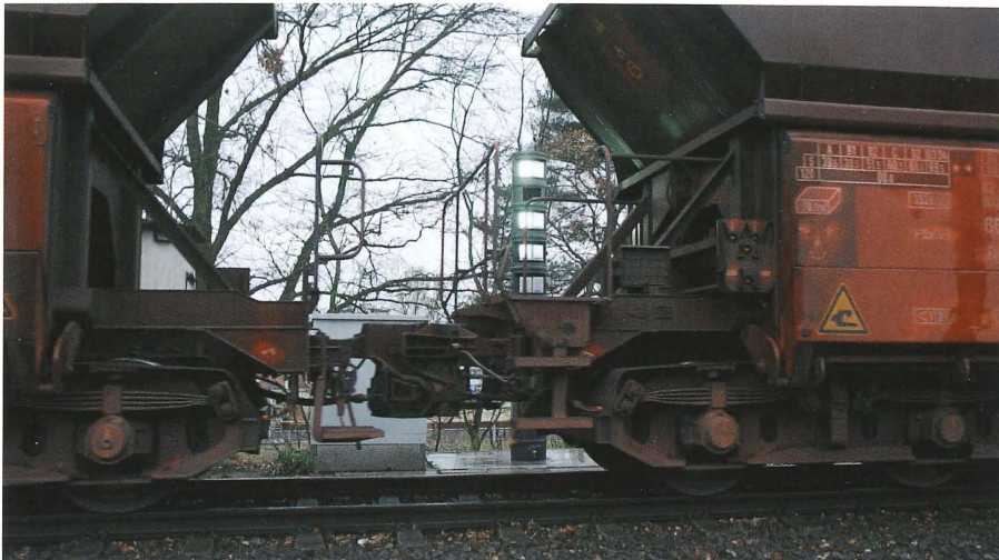
8: Überprüfung der Wagen durch die RDG-Säule
