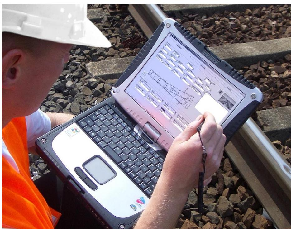
Abbildung 5: Visuelle und messtechnische Prüfung einer Weiche mit MR.pro®
