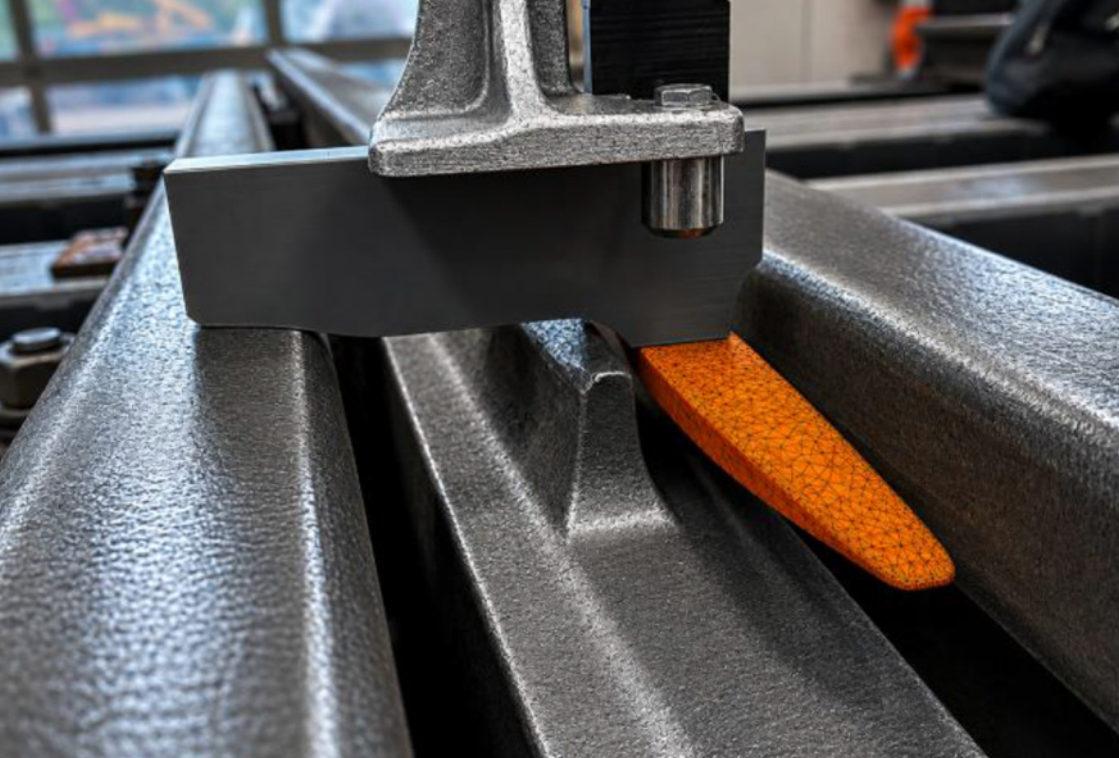
SpurKranzTaster (SKT) beim Check der Kontaktverhältnisse Herzstückspitze - Flügelschiene
